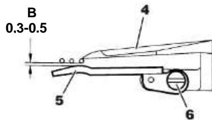
Когда петлитель 4 перемещается влево позади игл, между иглами и ограждением игл (передним) 5 должен соблюдаться зазор 0,3-0,5 мм (см. В). Для регулировки ослабьте винт 6 и передвиньте ограждение (переднее) иглы 5 вперед или назад.
