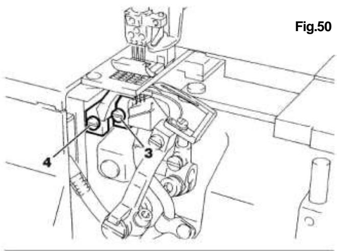
Когда прижимная лапка 5 поднята, отрегулируйте расстояние В от верхней плоскости игольной пластины до нижней поверхности прижимной лапки. Выберите расстояние в соответствии с применением машины, согласно спецификациям (см. стр. 50).
